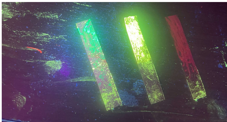
Рисунок 6. Лакмусовые бумажки с нанесёнными порошками [\text{Tb}(\text{Ox})_3(\text{Phen})] , [\text{Tb}(\text{Sal})_3(\text{Phen})] , [\text{Eu}(\text{Sal})_3(\text{Phen})]
